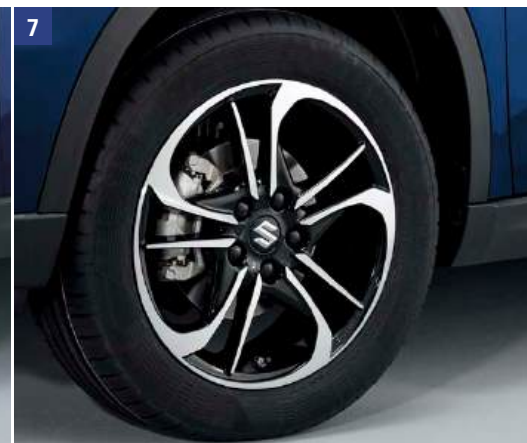
7 | Disk koleša z ľahkej zliatiny „MOJAVE“ Black Polished, 6,5 J x 17", WVTA pre pneumatiky 215/55 R17, vrátane stredovej krytky s logom S. Obj. čís. 43210-54PU1-OSP A D
