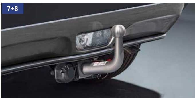
7 | Ťažné zariadenie 1 WVTA Odmontovateľné, pre prívesy a prepravné systémy. Maximálne zvislé zaťaženie : 75 kg Maximálna hmotnosť prívesu : 1 500 kg Obj. čís. 9911J-63U00-000
