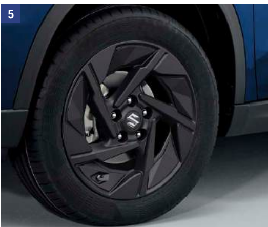
5 | Disk koleša z ľahkej zliatiny, Matte Black 1 WVTA 6,5 J x 17" pre pneumatiky 215/55 R17. Stredová krytka nie je súčasťou balenia. Obj. čís. 43210-63U70-0CB B E I J
